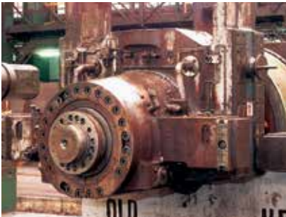
Yatak kasalarındaki ezme bilezikleri önceki yöntemlere göre daha yüksek önyüklemeler sağlıyor ve dolayısıyla en azami yükleri bile sönmülenebiliyor. Merdane boğazları dayanıyor ve üretim sorunsuz şekilde devam ediyor.
