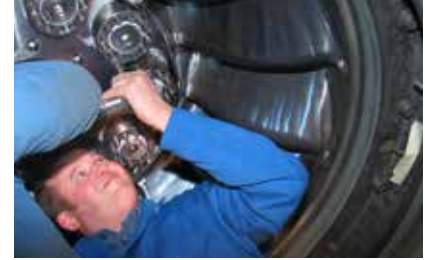
Superbolt gergileri ile aksi konumlardaki ve dar alanlardaki bağlantılar bile sıkıştırılabilir. Bu Francis pervanesinin düzenli bakım ihtiyacı vardır, ki bu pervaneyi şafta bağlayan MJG'ler ile yönetilebilir olmuştur.
