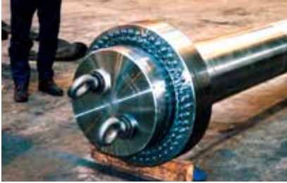
Dünyanın en büyük civata-tipi MJG'si, 28" çap x 40' uzunluk (711,2 mm çap ve 12,2 m uzunluk). Bu, büyük bir hidrolik dövme presinde kullanılmıştır.
