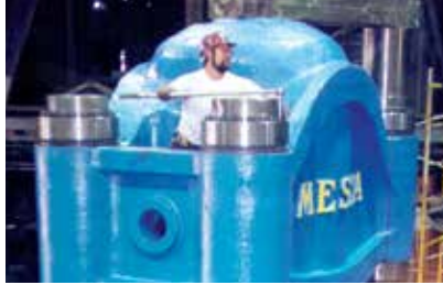
Sekiz adet Superbolt kolon somunu kurulum için sadece 12 adam-saate ihtiyaç duydu, buna karşılık kolonların ısıtılması için 2.5 tam gün gerekli.
