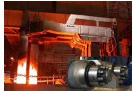
EAO elektrot kolu montajı. MJG'ler ile elektrot koluna etki eden yoğun titreşime dayanabilecek yüksek bir sıkıştırma yükü elde edilebilmektedir.
