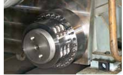
Bölünmüş-somun sıkma bilezikleri, Superbolt tarafından özel olarak tasarlanan ve büyük pres kolonlarındaki büyük dişli bağlantı elemanlarına kıyasla çok daha kolay şekilde kurulum sokülebilir ürünlerdir.
