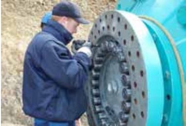
Rüzgar türbininde şanzıman kutusundaki flanş bağlantısı. İnanılmaz torku iletmek için Superbolt teknolojisi ile tümleşmiş dübelli civata kullanılmıştır. Bu çözüm, hem ufaktır, hem de gereksinimlerden biri olan fazla ağırlık eklenmesine neden olmamıştır.
