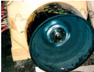
Superbolt mil motoru somunları, mil motorlarına fren balataları, kaplinler ve Makara bağlamak için tasarlanan özel sıkıştırma somunlarıdır. Motor imalatçıları tarafından sağlanan somunları doğrudan değiştirilebilirler.
